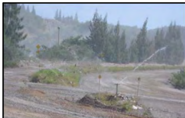
ระบบ Springer บริเวณเส้นทางขนส่งลำเลียง
